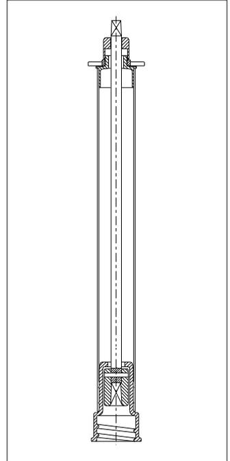
**Teleskop - Einbaugarnitur** für Hausanschlußschieber ( S )
