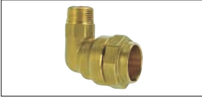
Typ 124 Winkelanschlußverschraubung 90° mit reduziertem Außengewinde
